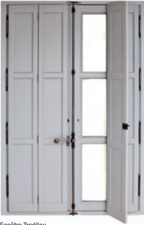
Fenêtre Tradilou Paumelle turlupet à plaque vissée pour la fenêtre et le volet intérieur Usinage spécifique du montant du volet si fermeture par espagnolette
