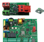
Retrofit kit simplifié E045S En remplacement d'une 455D (installée sans gatecoder) 390113E
