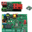
Retrofit kit simplifié E045S En remplacement d'une 455D (installée sans gatecoder)
