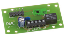
Interface Relais pour l'utilisation de récepteurs RP pour les connexions de fils
