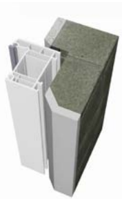
POSE EN FEUILLURE SANS RECOUVREMENT
