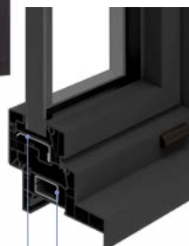
RENFORT 100% Profils acier dans l'ouvrant et le dormant si coloris plaxé 1 ou 2 faces
