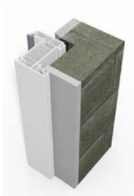
POSE EN FEUILLURE AVEC RECOUVREMENT
